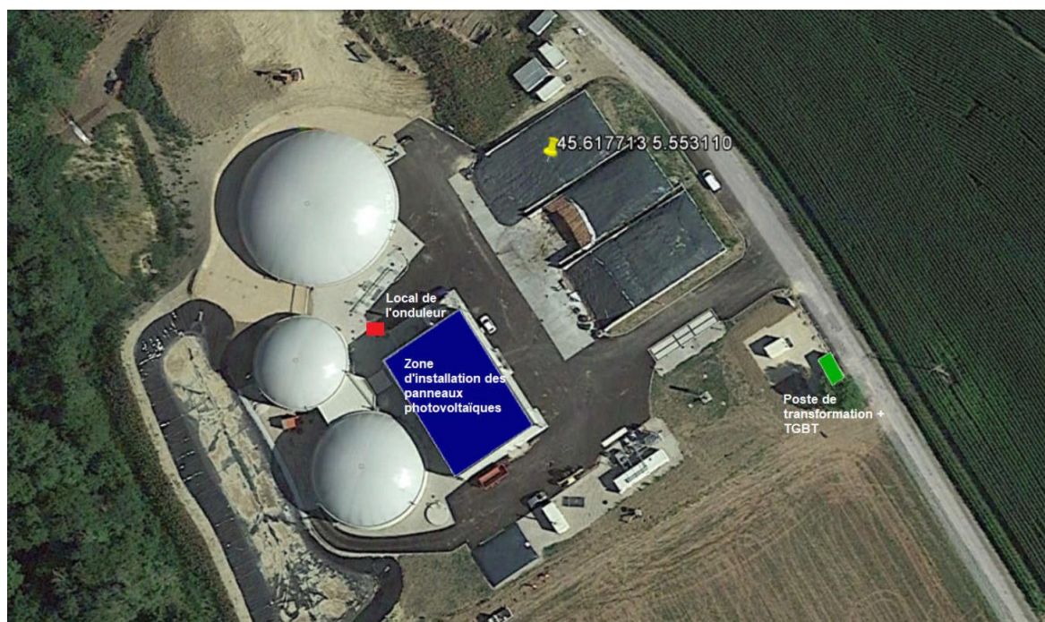
Figure 13 : Implantation des panneaux photovoltaïques
